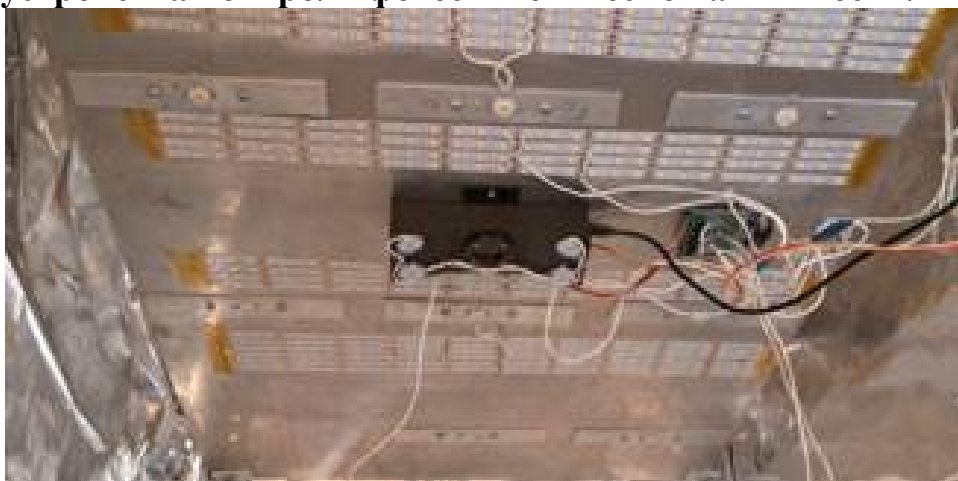
Рисунок 34. Устройство контроля фотосинтетической активности (черная коробка по центру фотографии), установленное в интеллектуальную систему управления освещением для повышения продуктивности сельскохозяйственных растений на основе данных о состоянии их фотосинтетического аппарата. Рисунок автора.
